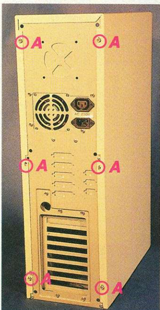
1: Der PC-Tower wie er im Originalzustand aussieht. Nun geht's ans aufmachen...
