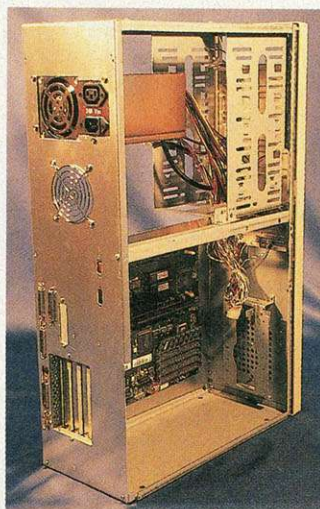
18: Netzteil, Slot-Blech-Halterung und Prozessorboard kommen an ihren Platz. Der Amiga nimmt langsam Form an und es ist immer noch sehr viel Platz für Erweiterungen vorhanden.
