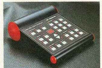
TBC-Enhancer: Neben vielfältigen Bildkorrekturen wird das Videosignal verbessert
